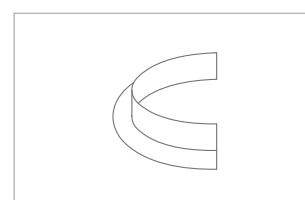
N° 8034/1 demi lune pour colonne intérieure Ø 250 – 500 mm au pas de 50 mm ; hauteur : 20 mm, largeur 20 mm, épaisseur : 1,5 mm
